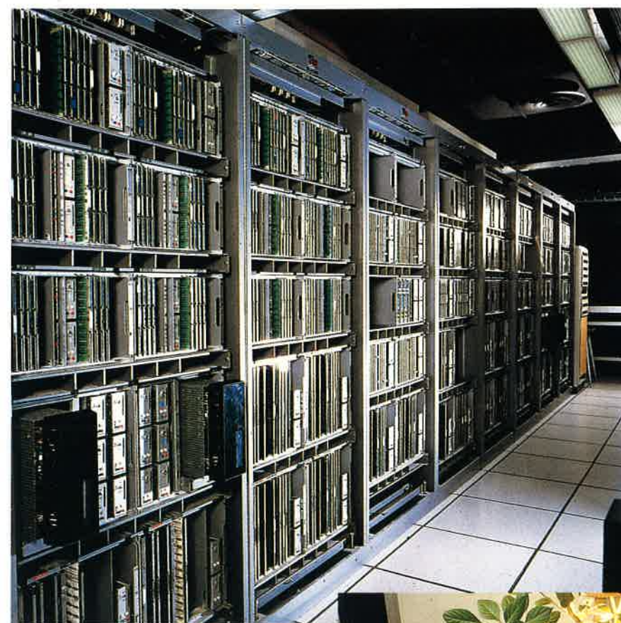
Le PAVI, point d'accès vidéotex, est l'interface entre le réseau téléphonique commuté et le réseau Transpac.
