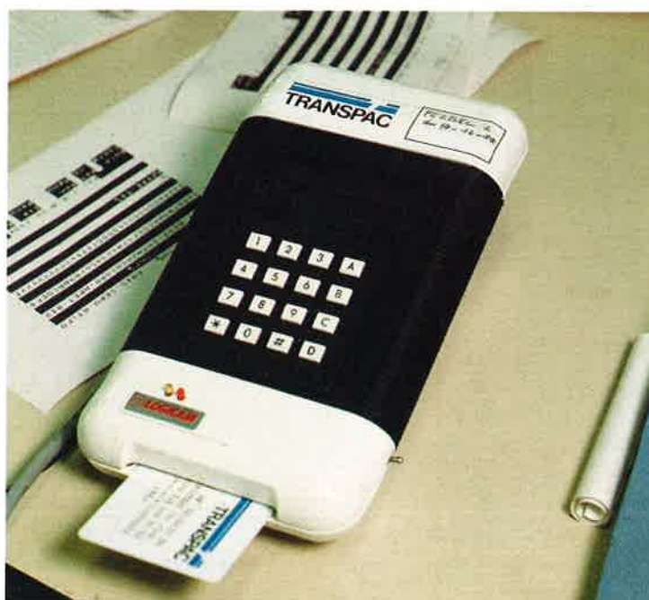
Pour la sécurité des transactions et, notamment, des transmissions d'ordres boursiers ou de télépaiement, le périphérique de sécurité qui permet d'authentifier l'utilisateur.
